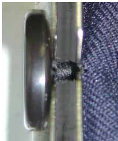
根巻き部、ほつれ止め液浸透後の状態
